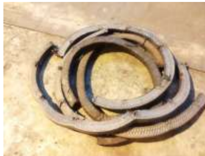
Gambar 2. Kerusakan yang terjadi pada Gland packing yang telah habis umur pakai.
