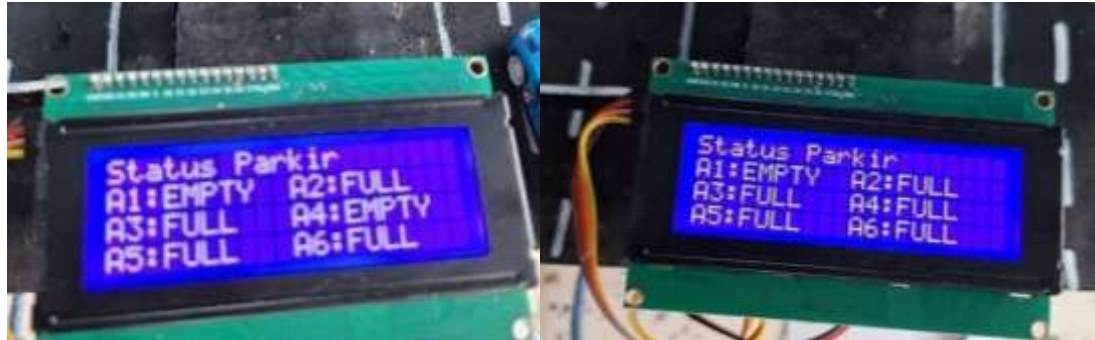
Gambar 8 Perubahan Tampilan Kondisi Slot Parkir
