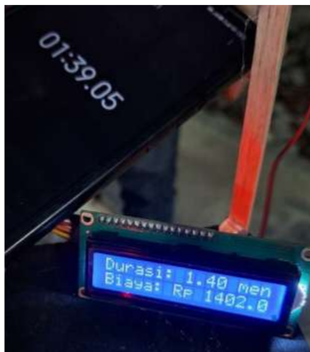
Gambar 11. Tampilan Durasi Waktu pada LCD dan Stopwatch
