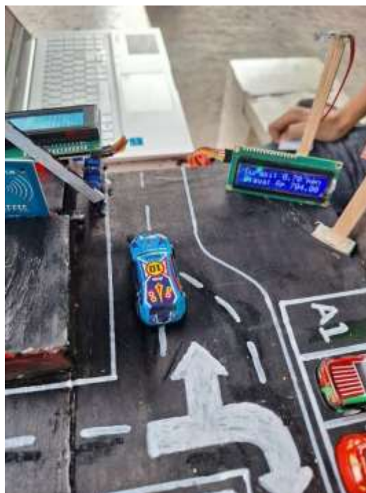
Gambar 9 Tampilan Biaya Parkir pada LCD
