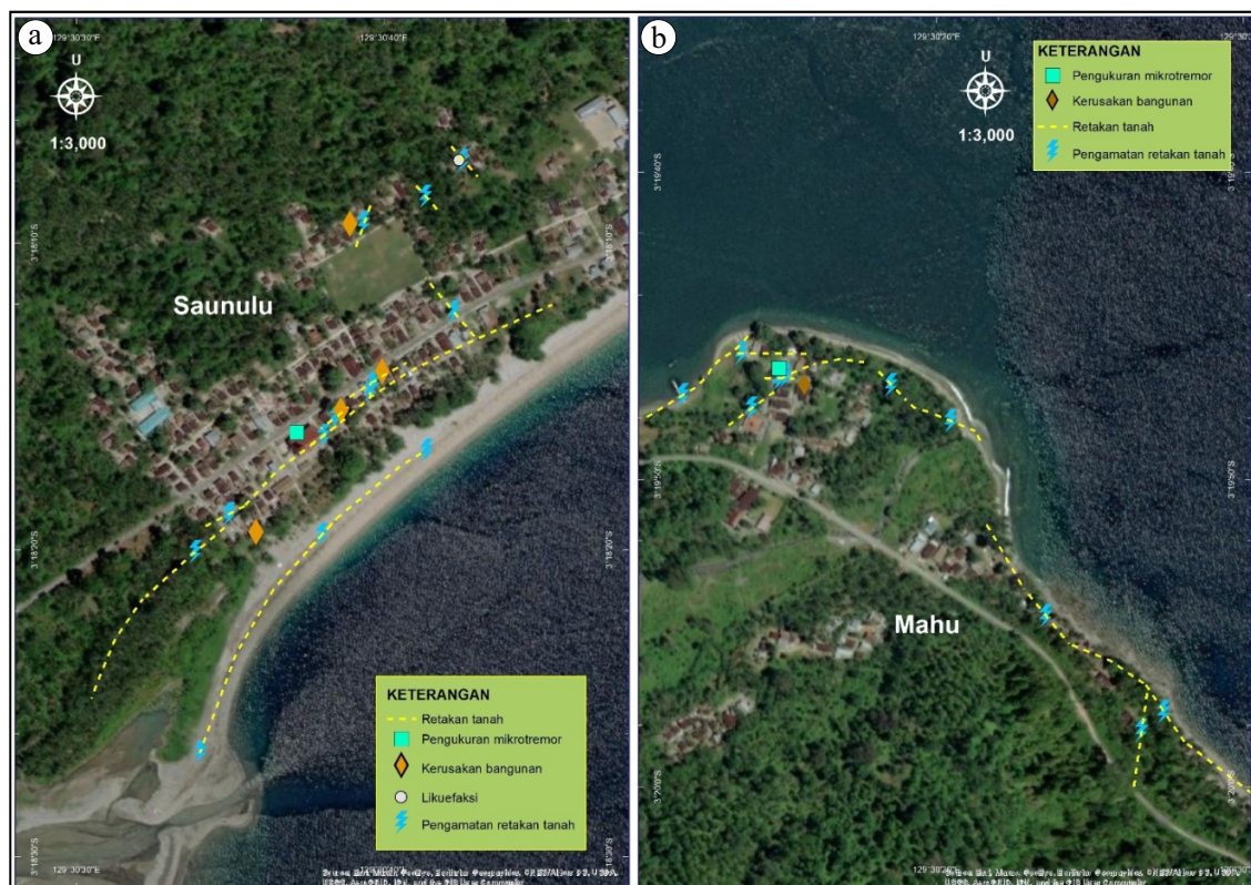
Gambar 6. Lokasi retakan tanah di Negeri Saunulu (gambar kiri) dan Dusun Mahu (gambar kanan) sebagai bahaya ikutan kejadian gempa bumi tanggal 16 Juni 2021. Peta dasar diambil dari google earth .
