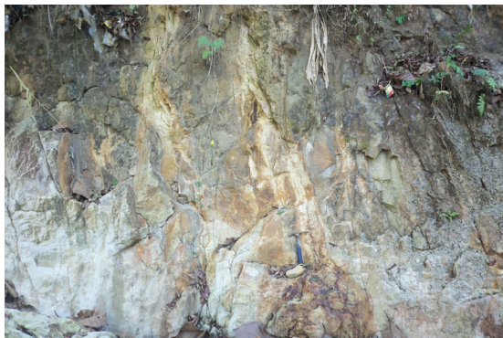
Gambar 5. Pengujian Kekuatan Batuan Utuh pada batuan lava andesit di Lokasi Penelitian dengan menggunakan palu geologi.
