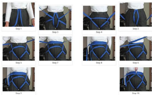
Gambar 12. Harness dengan menggunakan tubular webbing (Bundrank, Illank. 2012)
