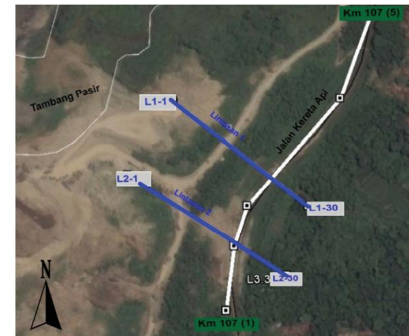
Gambar 3. Posisi lintasan pengukuran resistivitas (skala 1 : 3.448)
