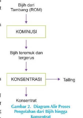
Gambar 2. Diagram Alir Proses Pengolahan dari Bijih hingga Konsentrat
