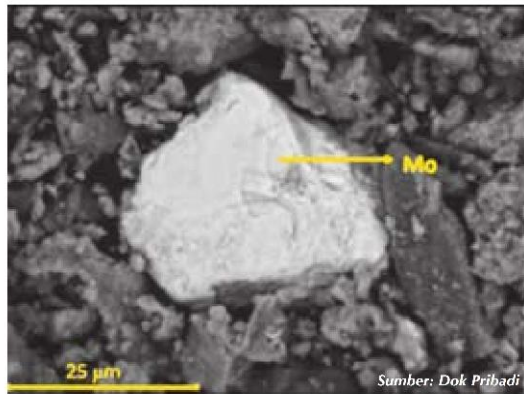
Gambar 5: Molybdenum sulphide dalam sampel S pada temperatur 269°C menggunakan SEM-EDX [4].
