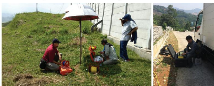
Gambar 3. Kegiatan survei menggunakan resistivity meter Naniura NRD-300 Plus dan AGI supersting R8/IP (sumber: Dokumentasi PPSDM Geominerba)
