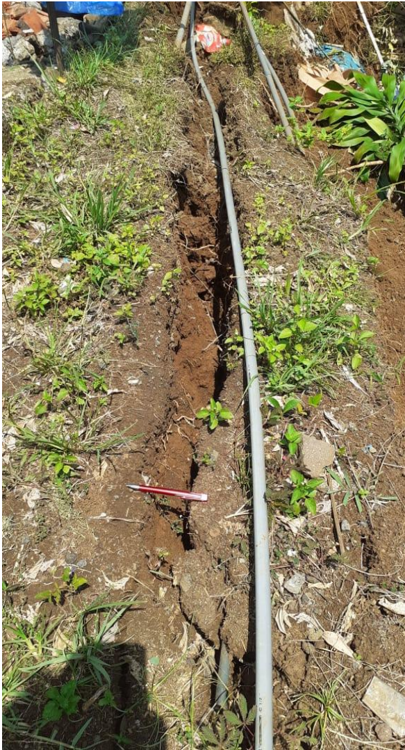
Gambar 1 Retakan tanah jenis lateral spreading berarah barat – timur dengan lebar sekitar 15 cm – 20 cm, akibat gempa bumi tanggal 10 April 2021, di Dusun Halimo, Desa Kaliuling, Kecamatan Tempursari, Kabupaten Lumajang (Dokumen penulis).
