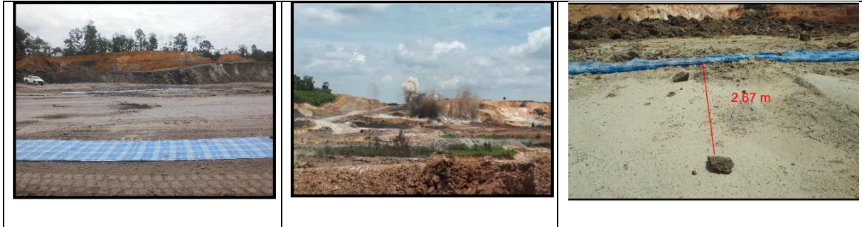
Gambar 6 Aktivitas pengukuran Lemparan Batuan ( Flying Rock )
