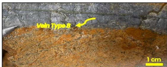
Gambar 28. Kenampakan urat tipe B dalam batuan diorit kuarsa
