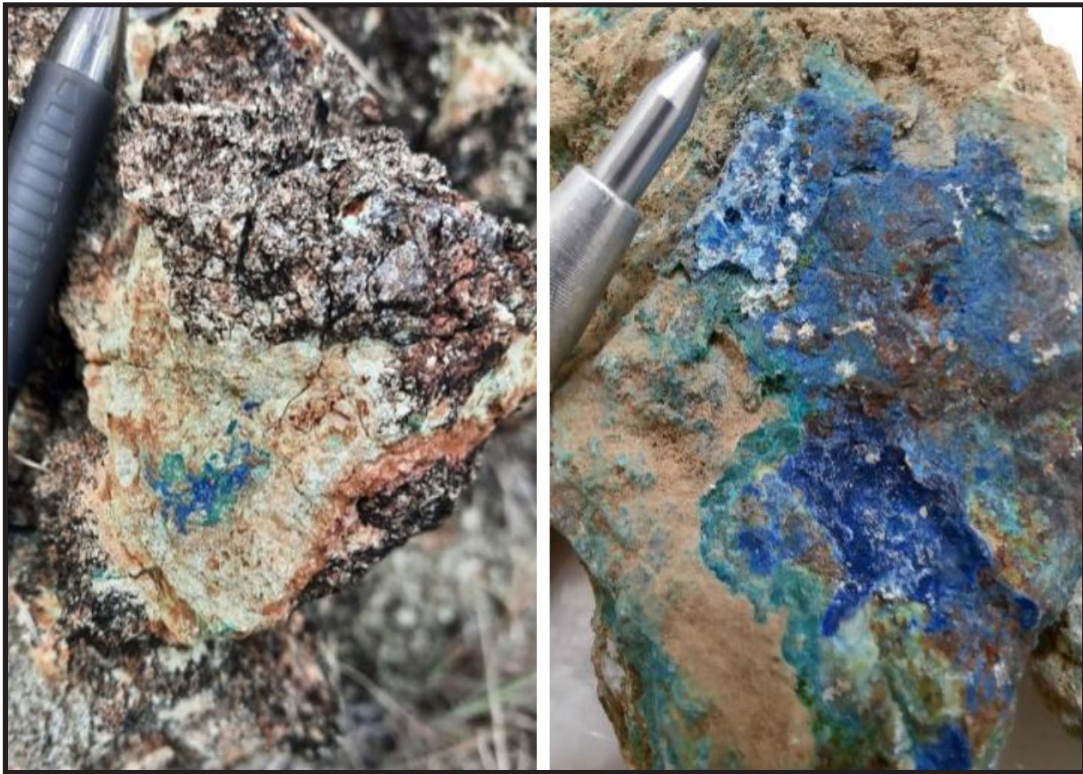
Kehadiran Mineral Bijih Kalkopirit, Bornit, Kalkosit, Kovelit, Azurit dan malakhit di Daerah Siron, Kecamatan Kuta Cot Glie, Kabupaten Aceh Besar, Provinsi Aceh (Tim Mineral, 2024)
