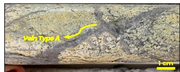
Gambar 26. Kenampakan urat tipe A dalam batuan diorit kuarsa
