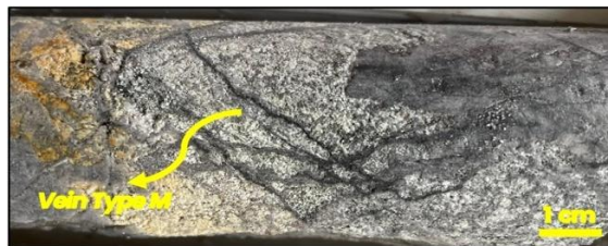
Gambar 31. Kenampakan urat tipe M dalam batuan diorit kuarsa
