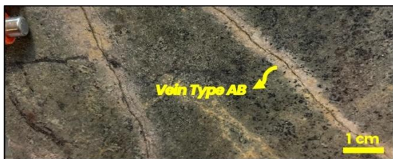
Gambar 27. Kenampakan urat tipe AB dalam batupasir
