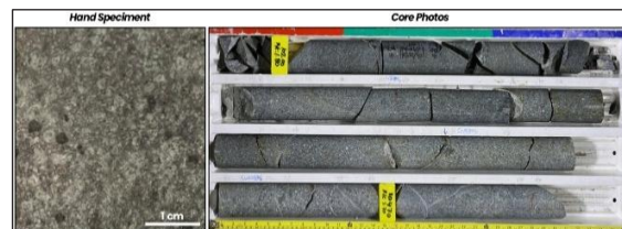
Gambar 13. Kenampakan Dasit fase 2 pada inti pengeboran R-56 (101,95 – 105,05 m)
