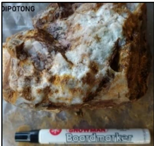
Gambar 6. Warna putih susu pada bijih urat kuarsa
