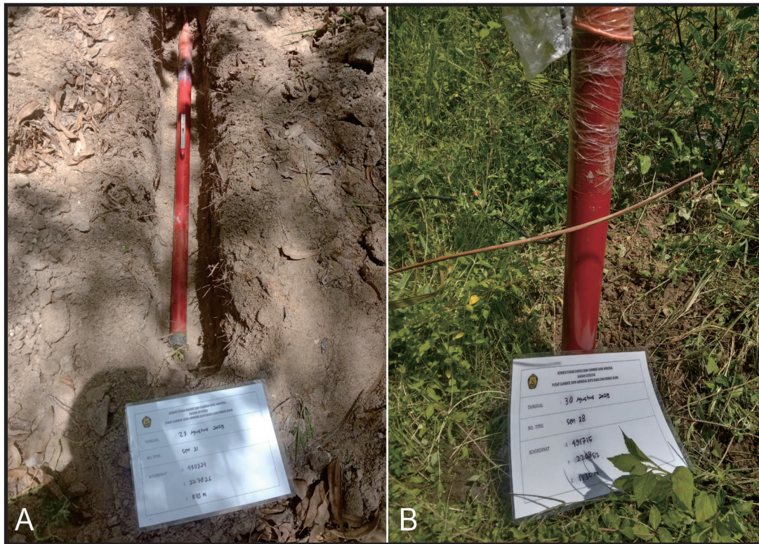
Pemasangan Sensor Magnetik. [A] HY (Horisontal) dan [B] HZ (Vertikal) di Daerah Sipoholon, Provinsi Sumatera Utara (Erwan Heryana, 2023)
