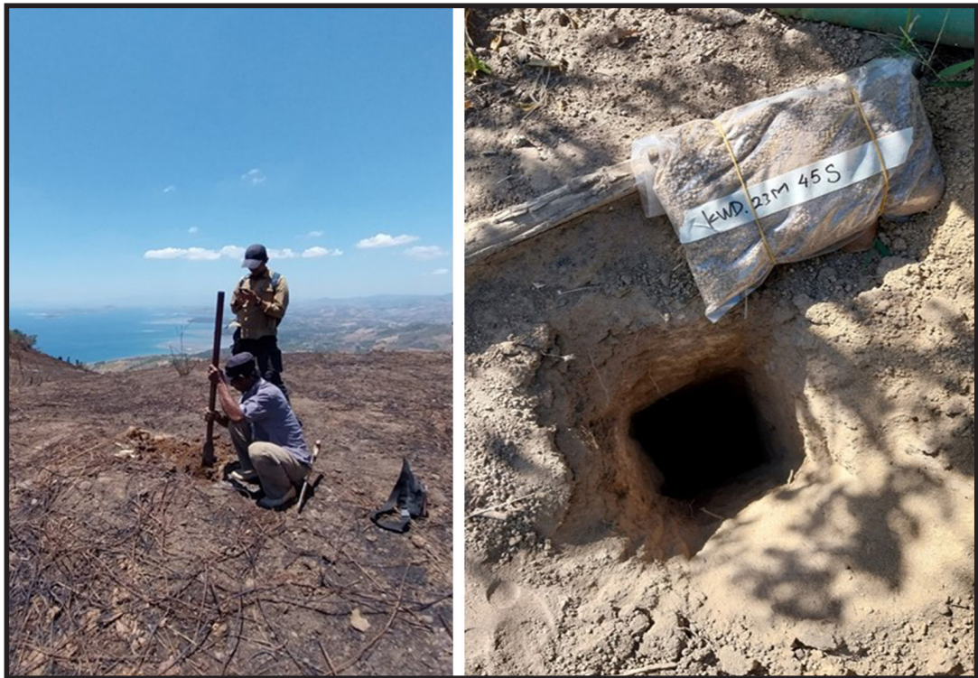
Pengambilan sampel tanah dengan metode Ridge and Spur pada zona horizon B Kecamatan Monano, Kabupaten Gorontalo Utara, Provinsi Gorontalo (Candra, 2023)
