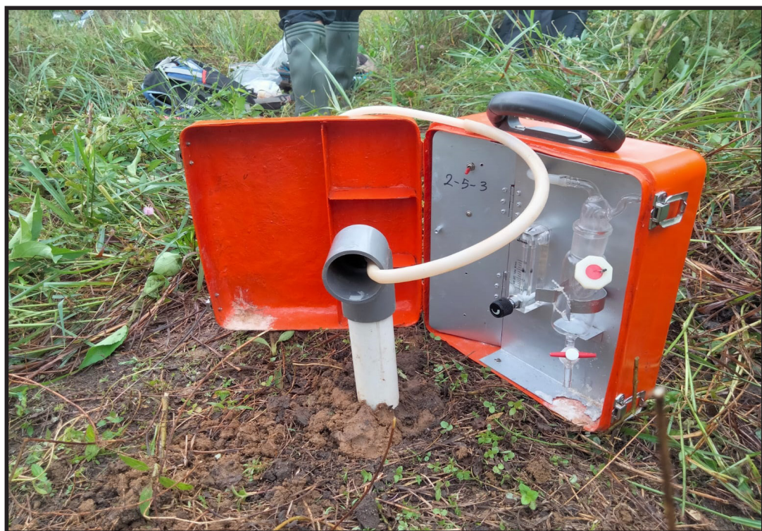
Pengukuran Hg tanah pada survei rinci geokimia Daerah Sipoholon Ria-Ria, Kabupaten Tapanuli Utara, Provinsi Sumatera Utara (Hamdi Anwar, 2023)
