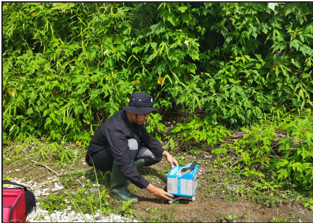
Survei potensi panas bumi dengan metode Gravity di Daerah Sipoholon, Provinsi Sumatera Utara (Erwan Heryana, 2023)
