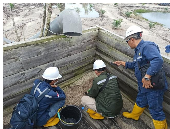
Gambar 6. Pengambilan sampel konsentrat dulang di sluice box
