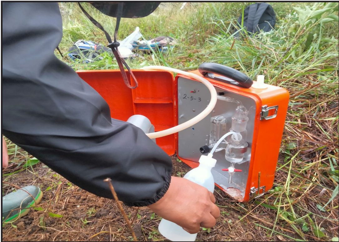
Pengukuran Hg, CO dengan NaOH pada survei rinci geokimia Daerah Sipoholon Ria-Ria, Kabupaten Tapanuli Utara, Provinsi Sumatera Utara (Hamdi Anwar, 2023)
