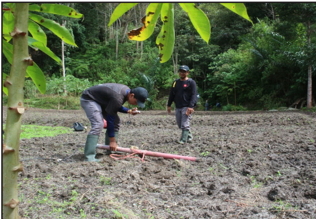
Pemasangan Sensor Magnetik(Coil) Horizontal Hx dan Hy dimana HY diarahkan ke utara dan selatan dan Hy di arahkan ke arah barat timur, sementara sensor Coil HZ ditanam Vertikal di Daerah Sipoholon, Provinsi Sumatera Utara (Erwan Heryana, 2023)
